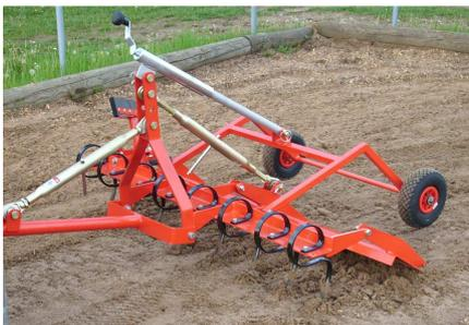
Der Reitplatzboden wird mittels acht Federzinken gelockert, und mit einem großen Planierschild geplant. Weil der RS Reitplatzplaner nicht starr mit dem Zugfahrzeug verbunden ist, und im Betrieb das Fahrwerk hochgeschwenkt wird, arbeitet der RS Reitplatzplaner exakt ohne Bodenverschiebung.
