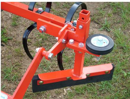
Der integrierte Kantenräumer kann werkzeuglos in die Arbeitsstellung geschwenkt und befestigt werden. Er ist höhenstellbar, und das Tastrad kann stufenlos auf jeden Reitplatz eingestellt werden.
