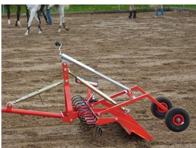
Beim RS Reitplatzplaner können die Arbeitstiefe der Federzinken sowie das Planierschild und die Anhängervorrichtung stufenlos über sehr stabile Spindeln auf Ihre Bedürfnisse eingestellt werden.
