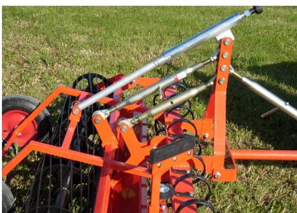
Beim RS Reitplatzplaner können die Arbeitstiefe der Federzinken sowie das Planierschild und die Anhängervorrichtung stufenlos über sehr stabile Spindeln auf Ihre Bedürfnisse eingestellt werden.
