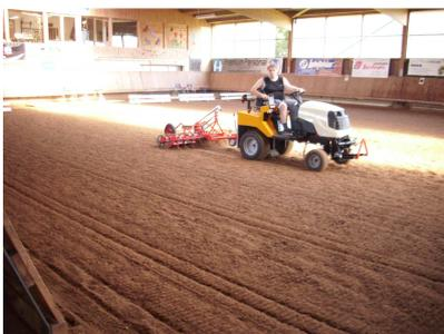
Der Reitplatzboden wird mittels zehn Federzinken gelockert mit einem großen Planierschild und Walze geplamt. Weil der RS Reitplatzplaner nicht starr mit dem Zugfahrzeug verbunden ist, und im Betrieb das Fahrwerk hochgeschwenkt wird, arbeitet der RS Reitplatzplaner exakt ohne Bodenverschiebungen.
