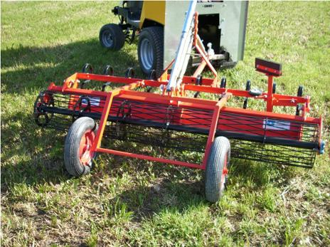
Mit dem integrierten Fahrwerk ist der RS Reitplatzplaner leicht zu transportieren. Das Fahrwerk kann mit der leichtgängigen Spindel sehr hoch ausgeboben werden, um in jeden Reitplatz einfahren zu können. Im Betrieb wird das Fahrwerk nach oben geschwenkt.
